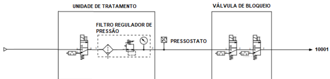
Figura 4. Cenário I - diagrama pneumático parcial da bancada 4.0 (ADAPTADO AUTORES).
