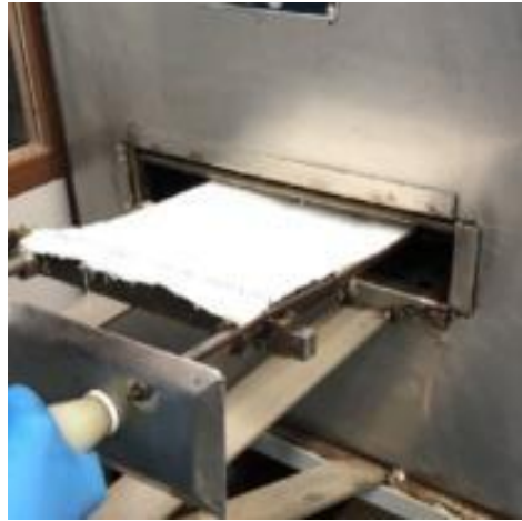
Estudo Para Substituição De Matéria-Prima Alternativa Em Um Amaciante Para Felpa Utilizada Em Uma Indústria Têxtil Figura 5 - Amostra entrando na rama.
