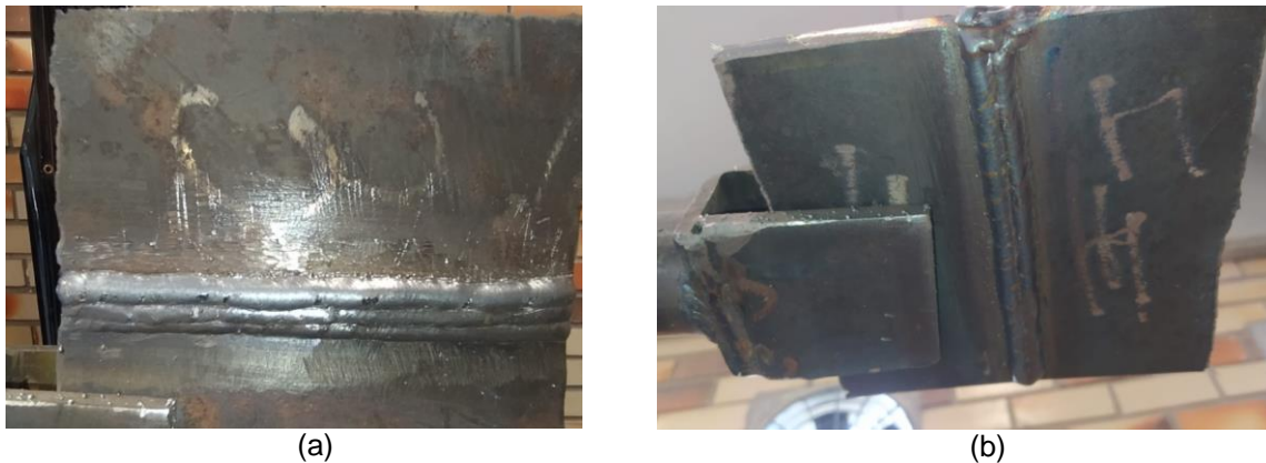
Figura 23. Corpos de prova soldados: (a) posição 2G e, (b) posição 4G (OS AUTORES).
