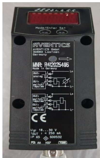
Figura 6 e 7, fluxostato instalado na bancada 4.0.
