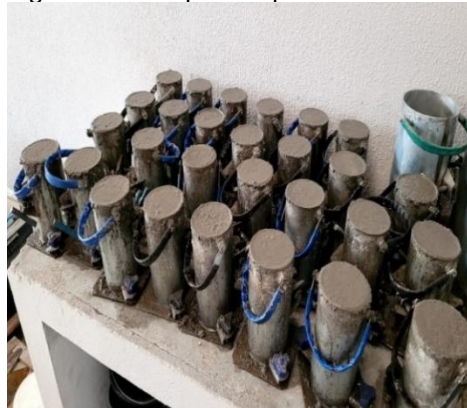
Figura 03 – corpos de prova enformados.
