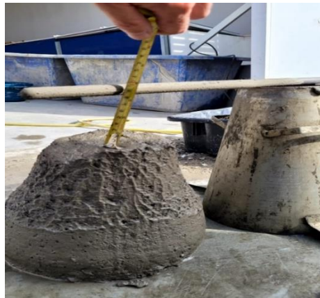
Figura 02 – Ensaio de abatimento de tronco.
