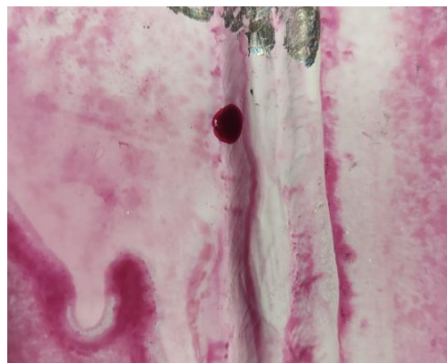
Figura 24. Presença de poro na junta soldada na posição 4G (OS AUTORES).
