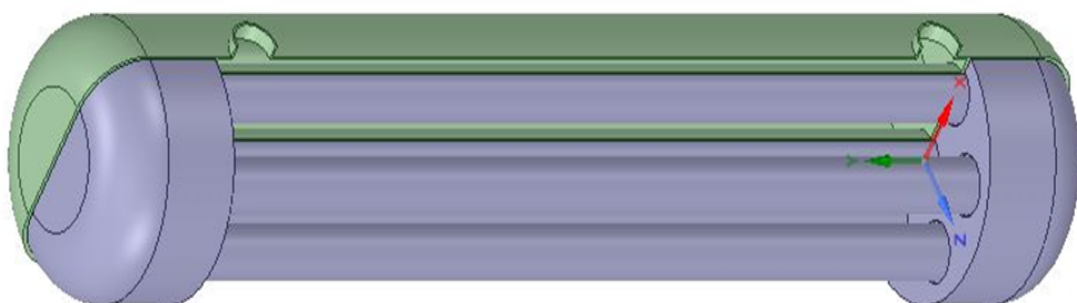
Figura 5 - Modelamento do trocador de calor (vista isométrica)
