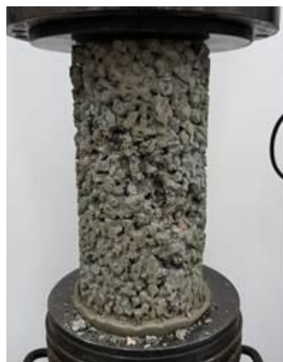
Figura 9 – Ensaio de resistência à compressão (Autores (2020))
