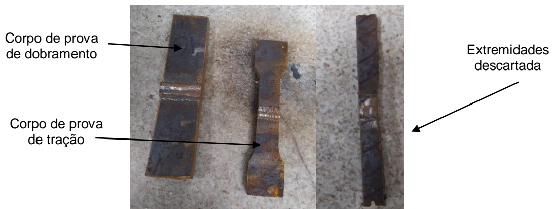
Figura 16. Corpo de prova de dobramento e tração para ensaios destrutivos e zona descartada (OS AUTORES).
