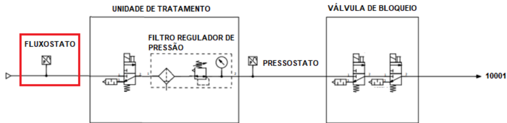
Figura 5. Cenário II - diagrama pneumático parcial bancada 4.0 com a instalação do fluxostato (ADAPTADO AUTORES).
