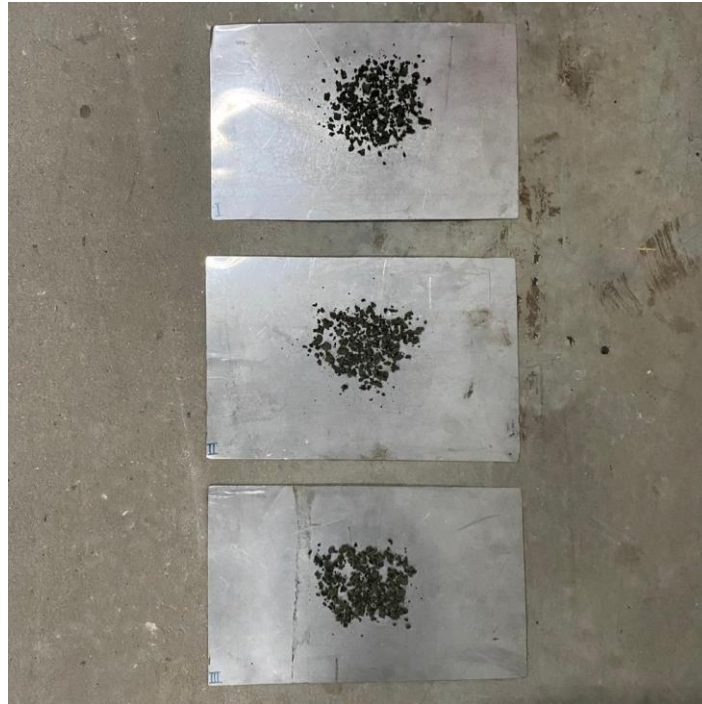
Figura 10 – chapas de inox com o lodo pós secagem.
