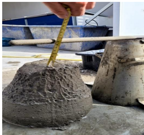
Figura 02 – Ensaio de abatimento de tronco.
