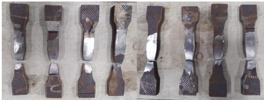
Figura 25. Corpos de prova após serem submetidos ao ensaio de tração (OS AUTORES).
