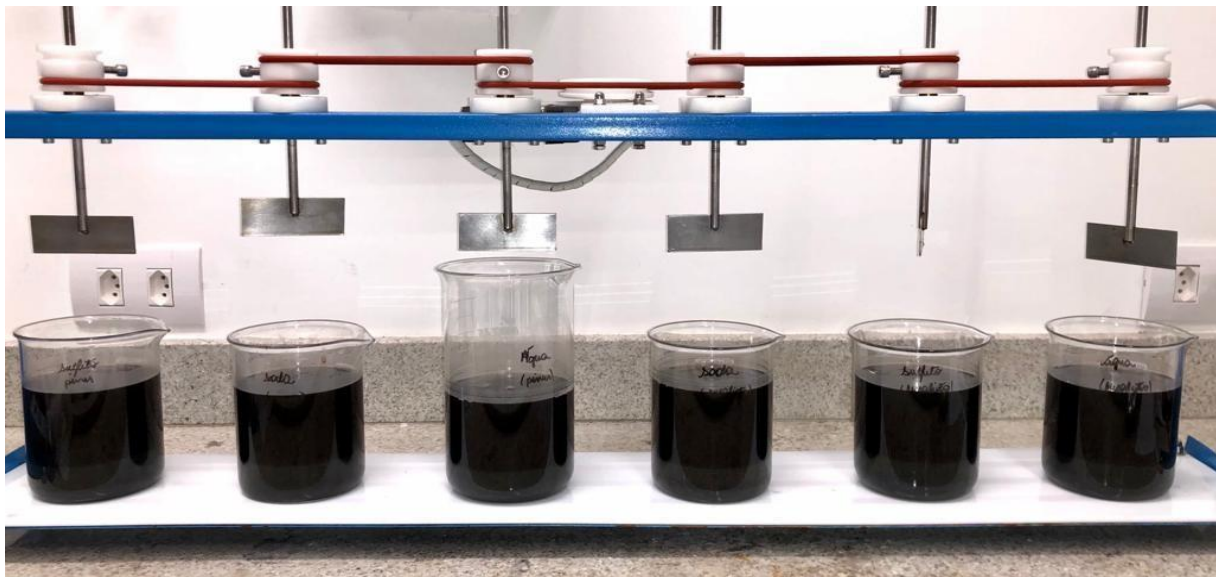
Figura 7 - Amostras de efluente preparadas para o ensaio no equipamento Jar test
