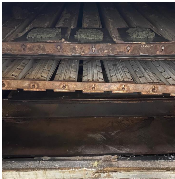
Figura 06 – chapas de inox com lodo para secagem no interior da rama.
