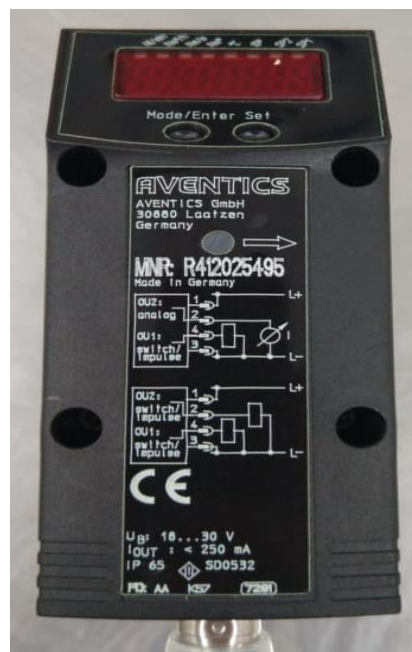
Figura 6 e 7, fluxostato instalado na bancada 4.0.
