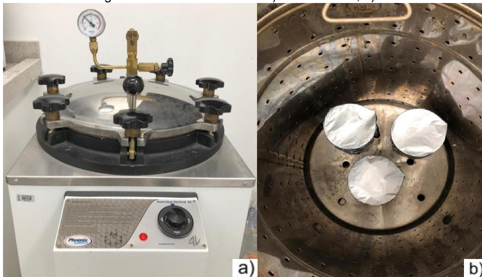
Figura 5 - Autoclave vertical. a) vista externa, b) vista interna
