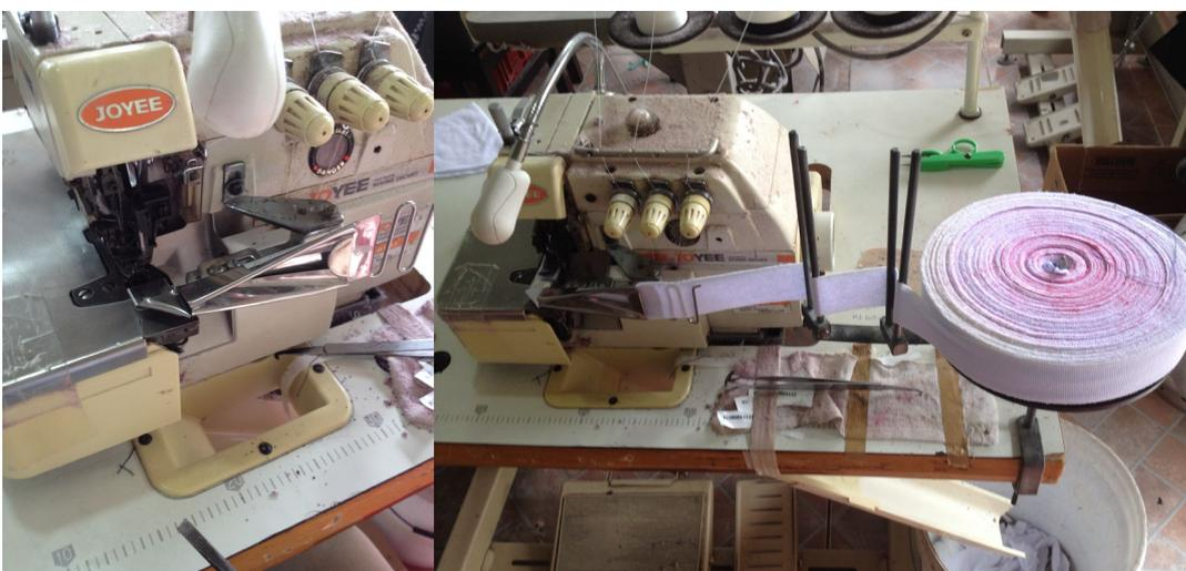
Figura 26: Instalação do aparelho e debrum para passar no decote - overlok
