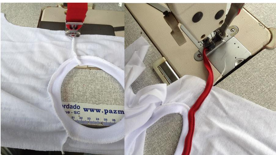
Figura 29: Passagem de reforço de gola no decote parte de traz - type
