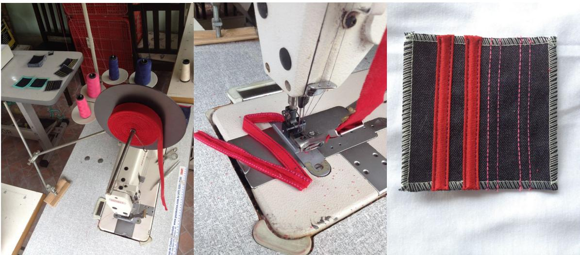
Figura 09: Parabólica aérea, aparelho de passagem de reforço e exercício de costura.
