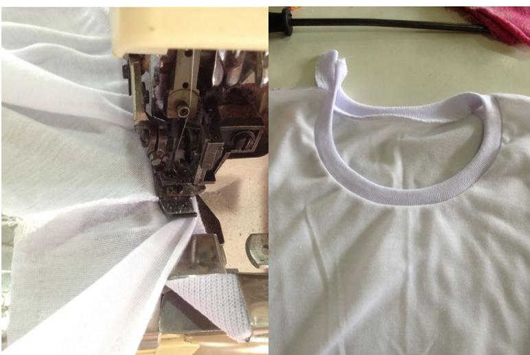
Figura 27: Passagem do debrum no decote - overlok
