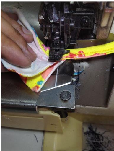
Figura 19: Arrematar ombro esquerdo - overlok com arremate.
