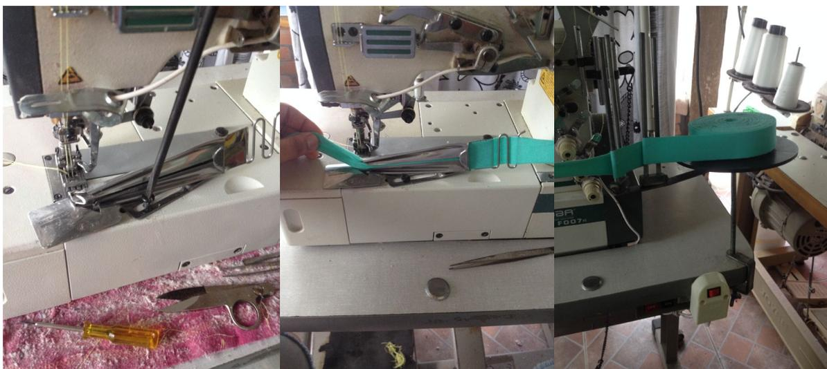
Figura 05: Aparelho de auxílio a passagem de debrum e rolo de debrum.
