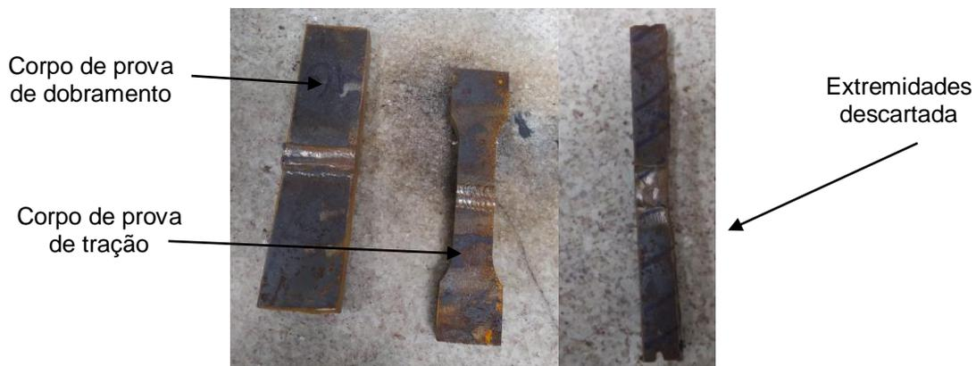
Figura 16. Corpo de prova de dobramento e tração para ensaios destrutivos e zona descartada (OS AUTORES).
