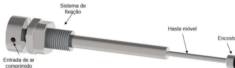
Figura 22. Projeto do sistema de posicionamento e expulsor máquina 2 (OS AUTORES).
