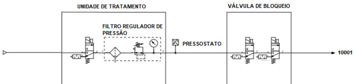
Figura 4. Cenário I - diagrama pneumático parcial da bancada 4.0 (ADAPTADO AUTORES).
