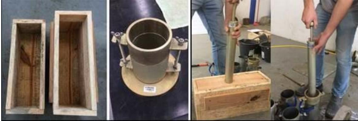
Após o procedimento de adensamento com soquete de 2,5Kg, fez-se a retirada da aba de proteção da forma e executou-se a rasadura da amostra. Posteriormente as amostras ficaram em repouso por um período de 48h para depois serem retiradas das formas e seguirem para a disposição em câmara úmida, permanecendo durante o período de cura de 28 dias. A figura 5 ilustra estes procedimentos.
