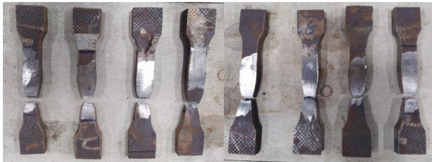
Figura 25. Corpos de prova após serem submetidos ao ensaio de tração (OS AUTORES).
