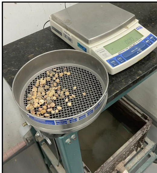
Figura 9 - Teste de granulometria
