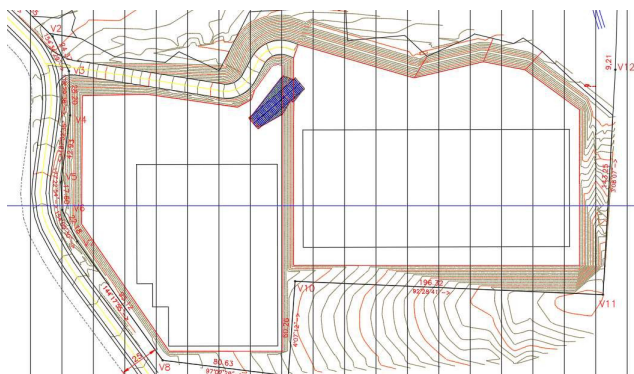
Figura 3 – Projeto com Curvas de Nível - Alinhamento em Azul na Horizontal e Sample lines em preto na vertical
